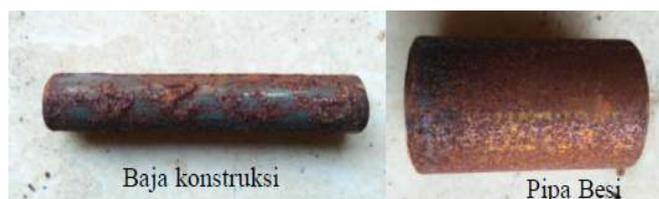
**Gambar 4. Spesimen yang telah terkorosi.**
